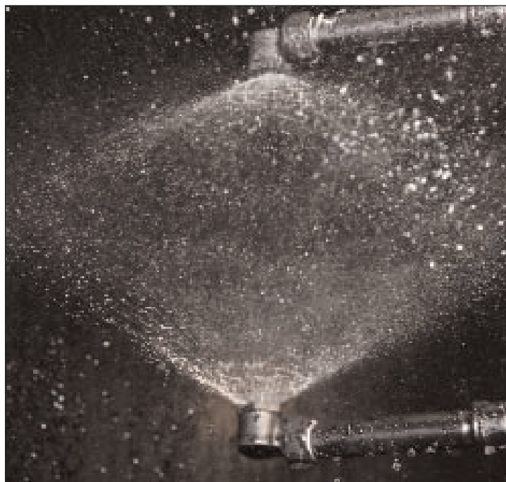
Speciální uspořádání trysek – vyšší kontaktní plocha pro vázání prachu a NH 3
