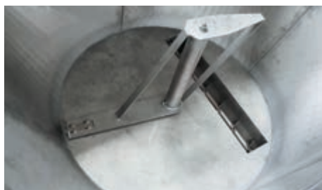
Dno nádrže s řepelí ve tvaru Z a vynášecím řnekem
