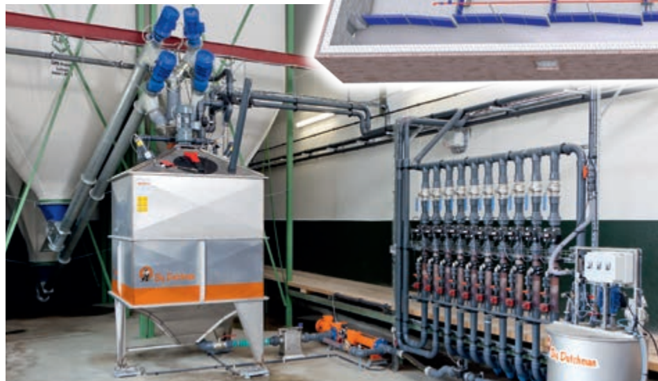
Krmná kuchyně: Zařízení s 1 nádrží se zaplněnými větvemi pro stáj s 2000 zvířaty
