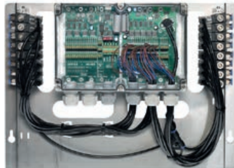
Slučovací jednotka pro pneumatické ovládání krmných ventilů
