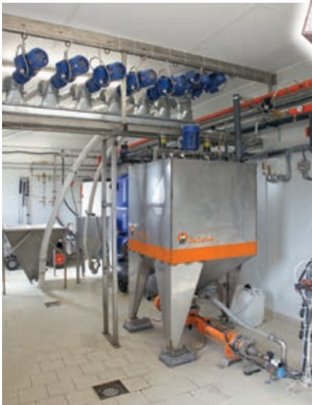
Krmná kuchyně: Bezezbytkové zařízení s 1 nádrží a tlakovým vzduchem
